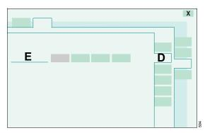
Аппарат Evita XL отображает Исх.режим и три дополнительных режима вентиляции в строке **Режимы** (E). После включения аппарата Evita XL эти режимы вентиляции будут отображаться в диалоговом окне **Настройка аппарата**.
